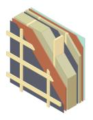
Außenwand 337 mm (hinterlüftete Fassade) – Mineraldämmung (245 mm), OSB 3, Konstruktionsholz, Gipskartonplatten, Super Defusionsmembran, Dampfsperre
