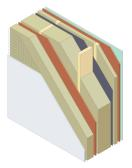
Außenwand 337 mm (Fassadenputz) – Mineraldämmung (290 mm), OSB 3, Konstruktionsholz, Gipskartonplatten, Mörtel-Fassadenputz, Fassadengewebe Glasfasernetz
