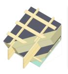
Satteldach 413 mm Mineraldämmung (335 mm), OSB 3, Konstruktionsholz, Gipskartonplatten, Super Defusionsmembran, Dampfsperre
