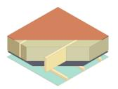
Decke 310 mm Mineraldämmung (245 mm), OSB 3, Konstruktionsholz, Gipskartonplatten, Dampfsperre
