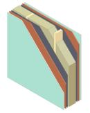
Innenwand 244 mm (tragend) – Mineraldämmung (195 mm), OSB 3, KVH Konstruktionsholz, Gipskartonplatten, Dampfsperre
