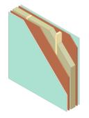
Innenwand 115 mm (nicht tragend) – Mineraldämmung (70 mm), OSB 3, Konstruktionsholz, Gipskartonplatten
