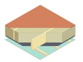
Decke 310 mm Mineraldämmung (245 mm), OSB 3, Konstruktionsholz, Gipskartonplatten, Dampfsperre
