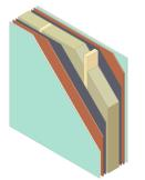
Innenwand 244 mm (tragend) – Mineraldämmung (195 mm), OSB 3, KVH Konstruktionsholz, Gipskartonplatten, Dampfsperre
